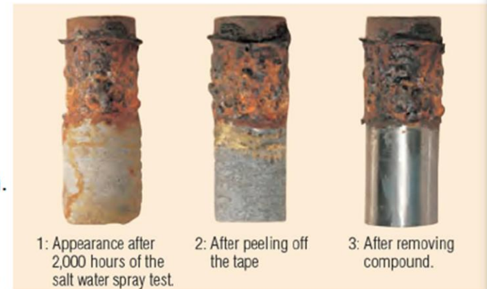
Hình số 1. Bề ngoài của mẫu thử nghiệm sau 2000h phun muối
