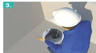
3. Trộn chống thấm Aquashutter 2 thành phần A:B = 18:30 theo trọng lượng. Trộn bằng máy khuấy ở tốc độ thấp (300-500 rpm) cho đến khi đồng nhất.
